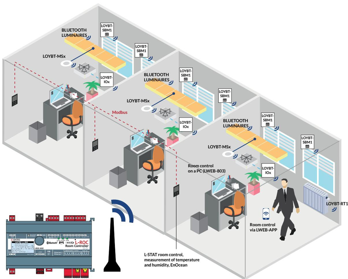
LROC-800 房間控制器最多可控制 3 個房間區段，並可根據不同房間區段類型，在層次結構中模擬更大規模的建築。各個區域可由區域經理進行合併多個區域控制器而予完成。一個樓層管理員管理該樓層的多個區域。根據不同的架構，該建物可以根據需要再劃分成區域和樓層。
