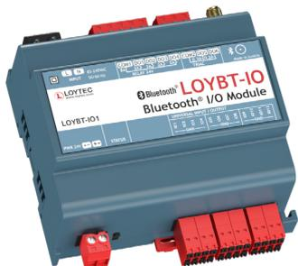
LOYBT-IO1は、認定されたBluetooth SIG Meshインターフェイスを備えたコンパクトなI/Oモジュールです。12個のユニバーサルI/Oと6個のデジタル出力(リレー x 4、トライアック x 2)
