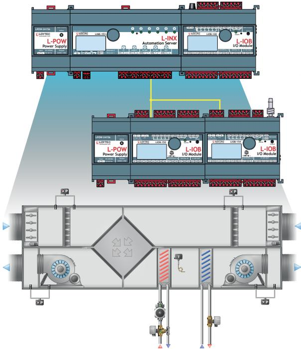
Les automates programmables L-INX sont de puissants équipements multi-protocoles dont les capacités peuvent être augmentées par le raccordement de modules d'entrée sortie plug'n play L-IOB. Les automates serveurs L-INX offrent des fonctions intégrées d'alarme, de programme horaire et d'historisation (AST™), mais également peuvent envoyer des courriels et héberger des pages graphiques dynamiques accessibles via un navigateur Web standard.
