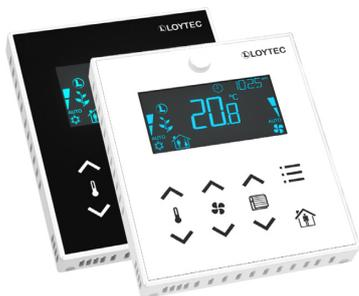
Le L-STAT est un boîtier d'ambiance ayant un look moderne qui s'insère dans n'importe quelle pièce. Il est directement connecté à un contrôleur LOYTEC ayant une interface Modbus. Jusqu'à 16 équipements L-STAT peuvent être connectés à un contrôleur. Le L-STAT est équipé d'un afficheur LCD segmentaire
