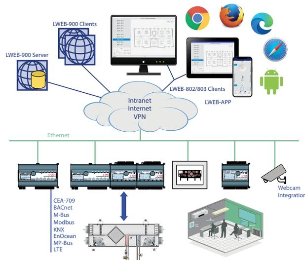
programme horaire et d'historisation (AST™) distribuées sur les équipements LOYTEC L-INX, L-ROC, L-VIS, L-DALI, les contrôleurs LIOB I/O, LIOB-AIR et L-GATE sont automatiquement synchronisées avec le serveur LWEB-900. Ainsi, les fonctions AST™ sont rapidement prêtes et déployées aux endroits utiles dans le bâtiment, et pleinement intégrées dans le système L-WEB.
