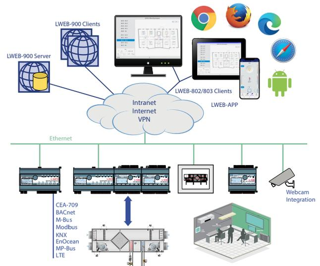
y dispositivos. Las funciones de Alarmas, horarios y tendencias (AST™ - Alarming, Scheduling & Trending) distribuidas en los dispositivos LOYTEC son sincronizados de manera automática con el servidor LWEB-900. Las funciones AST™ están listas cuando se necesiten y completamente integradas en el sistema L-WEB.
