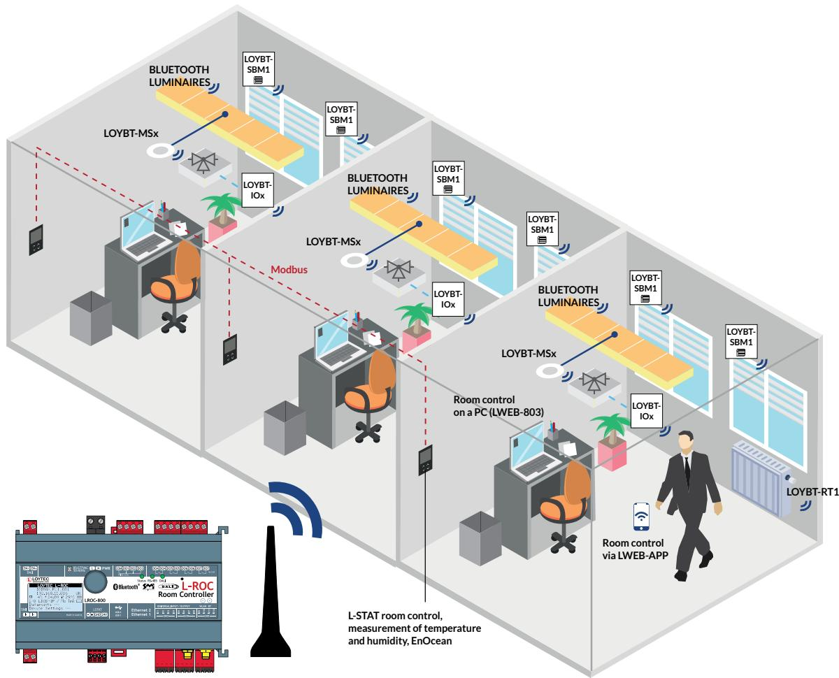
LROC-800 房间控制器最多可控制 3 个房间区段，并可根据不同房间区段类型，在层次结构中模拟更大规模的建筑。
