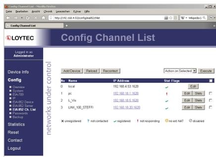
各型 L-IP 路由器，即 LIP-1ECTC, LIP-3ECTC, LIP-33ECTC 以及 LIP-3333ECTC，可连接双绞线信道 (TP/FT-10 或 TP/XF-1250) 至 LonMark 系统中的以太网/IP 信道 (IP-852)。L-IP 可发送 CEA-709 封包，通过 IP 网络，例如：LAN (以太网)、内网或什至互联网。
