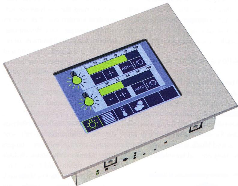
Visualisierung der auch im neuen LOYTEC-Zubau verwendeten Automationsfunktionen (hier Licht). Wirklich benötigt werden Raumbediengeräte bei LOYTEC aber eigentlich nicht mehr: Bewegungsmelder in den Räumen, eine Mausebewegung oder ein Drücken auf die Tastatur am Arbeitsplatz meldet dem Leitstand einen Raum als „belegt“ – die Room Controller setzen im Hintergrund die erforderlichen Klimatisierungs- und Wohlfühlschritte.
