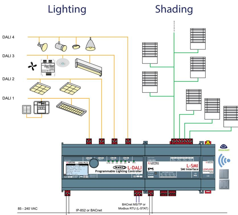
L-DALI控制器具备DALI灯光控制，以及DALI(Digital Addressable Lighting Interface)与LonMark系统或BACnet网络之间的网关的多功能装置。除了DALI镇流器(Ballast)，也支持DALI按压开关耦合器(Couplers,例如: LDALI-BM2)、多传感器(例如,LDALI-MS2)与继电器模块LDALI-RM5/LDALI-RM6。
