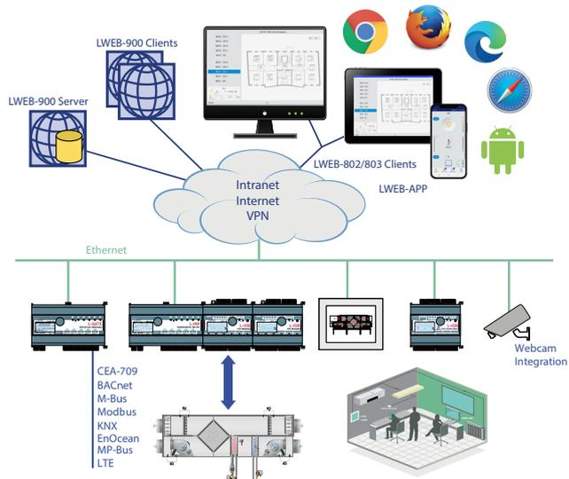
系统与用户的互动，都会依照用户分别记录。分散于LOYTEC L-INX, L-ROC, L-VIS, L-DALI, L-IOB I/O控制器, LIOB-AIR与 L-GATE装置上的警报、排程与趋势记录(AST)，可以自动同步到LWEB-900服务器。如此一来AST功能在楼宇自动化系统需要的时候，能够立即提供数据，并且集成到L-WEB系统中。
