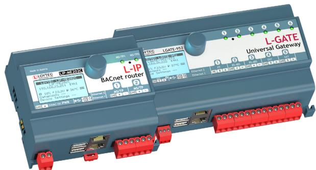
各型 L-IP 路由器，即 LIP-1ECTC, LIP-3ECTC, LIP-33ECTC 以及 LIP-3333ECTC，可连接双绞线信道 (TP/FT-10 或 TP/XF-1250) 至 LonMark 系统中的以太网/IP 信道 (IP-852)。L-IP 可发送 CEA-709 封包，通过IP 网络，例如：LAN (以太网)、内网或甚至互联网。
